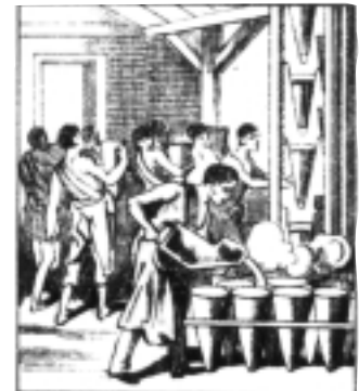
Le MOULAGE en sucre en forme, s'opère en versant le sucre cuit dans des vases de 150 litres ayant la forme d'un pain de sucre renversé; la masse coule versée bouillante et se refroidit pendant 24 heures environ.
