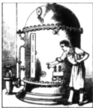
Le jus clair filtré sur du noir animal est évaporé, puis soulevé à l'APPAREIL à SUCRE, d'où il sort à l'état de cristaux qui sont séparés du strop restant, essorés, et expédiés en raffinerie.
