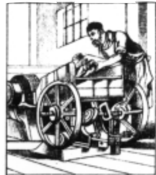
D'abord lavée à grande eau, la betterave est ensuite soumise au RAPAGE qui la réduit en pulpe. Les pulpes sont pressées entre des sacs de laine et le jus qui sort des pressas s'écoule dans des canaux où il est mélangé avec un lait de chaux.
