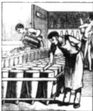
On porte le pain dans d'immenses chambres où, après cuisson, le pain est séché. Le sucre s'écrase lentement, mais comme les cristaux sont encore collés par le sirop qui y adhère, on verse sur le pain du sirop pur et l'écouleur qui déplace le premier et blanchit le pain. C'est ce qu'on appelle le blanchage du sucre .
