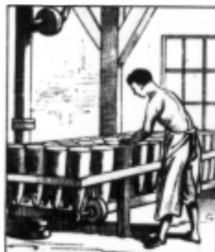
Afin de précipiter l'écoulement du sirop de clairage par le petit trou ménagé au bas de toutes les formes à pain de sucre, on les place sur un appareil nommé SUCETTE , qui, à l'aide du vide opéré dans l'appareil, assure et accélère rapidement le sirop resté liquide : le sucre cristallisé peut sécher alors rapidement.
